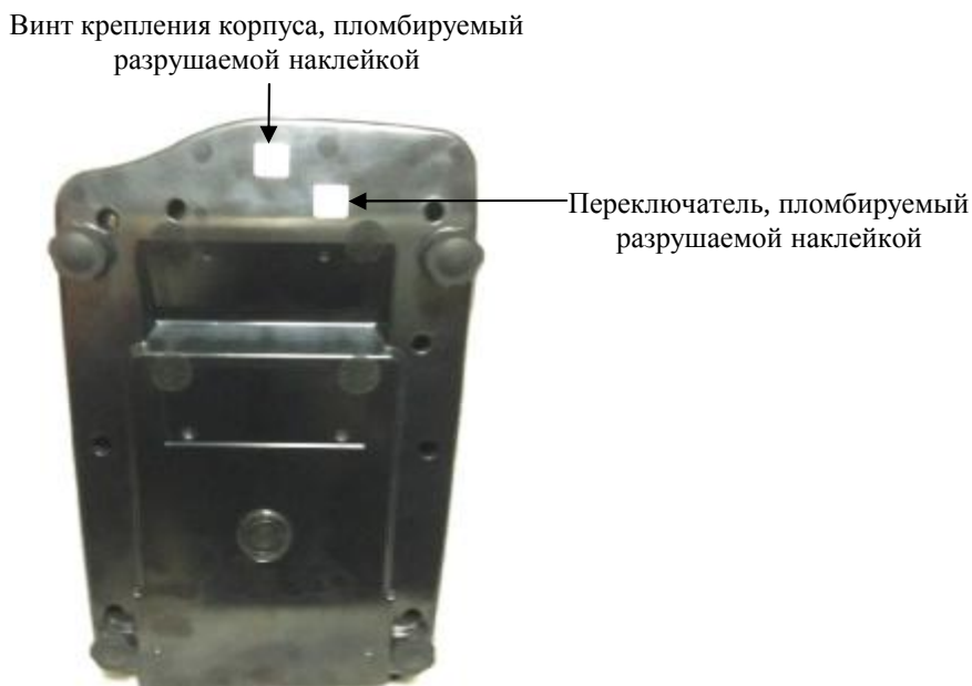
Рисунок 2 - Схема пломбировки весов от несанкционированного доступа.
