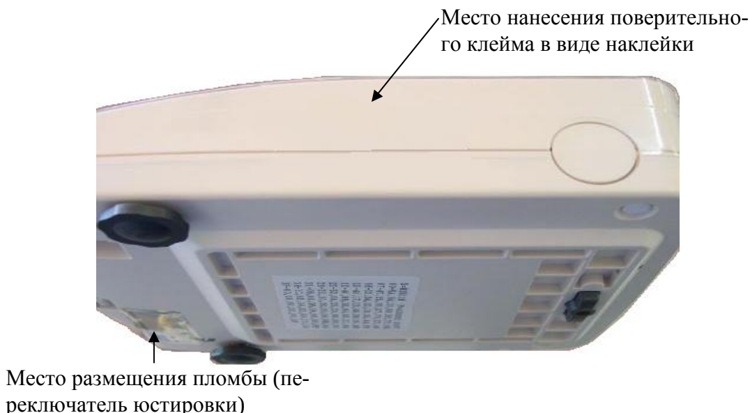
Рисунок 2 - Место нанесения поверительного клейма и схема пломбировки от несанкционированного доступа.
