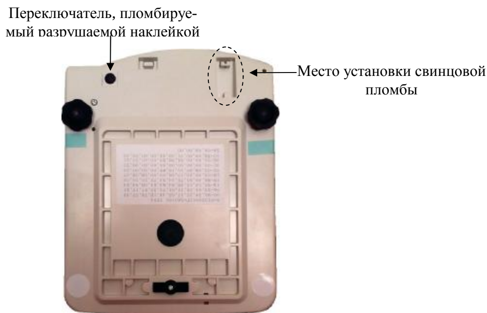
Рисунок 2 - Схема пломбировки весов от несанкционированного доступа.
