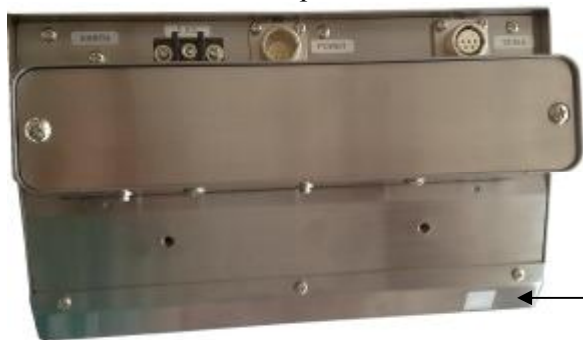
Рисунок 2 - Схема пломбировки от несанкционированного доступа
